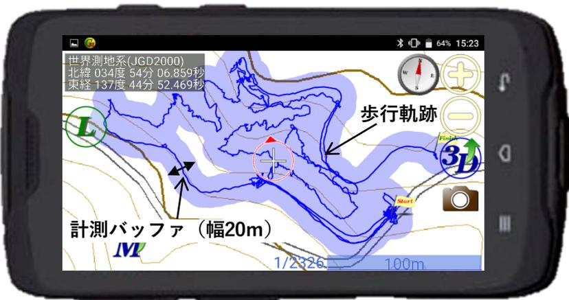
ポータブルGISシステムを実装したGNSSロガー
